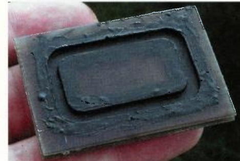
Obr. 4. Nanesená vrstva asfaltového separátoru
