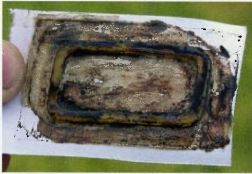
Obr. 5. Odlitek po vyjmutí z formy
