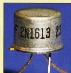
Obr. 2. NPN tranzistor typu 2N1613, výrobek Fairchild (1963)
